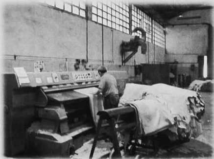
Treball actual amb les màquines de rebaixar modernes. En el cas de la TMFESAL, avui es fa un tractament integral dels residus generats en el rebaixatge de les pells, que es destinen a l'elaboració d'aglomerats de pell.
