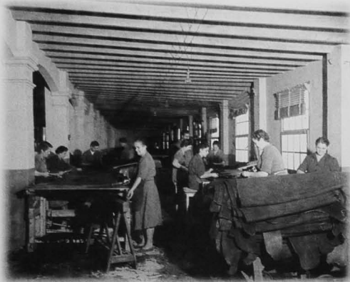
Imatge dels treballadors que en la fase d'acabat retallen, en un procés manual, les pells per acabar de condicionar-les.
