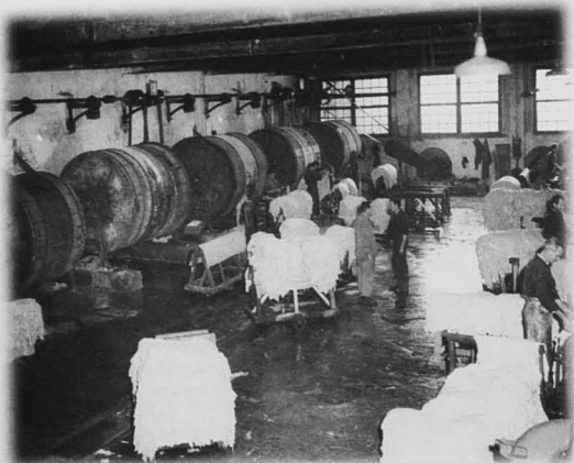
Bombos rotatoris i operacions d'escórrer després de remullar les pells en aigua freda.
