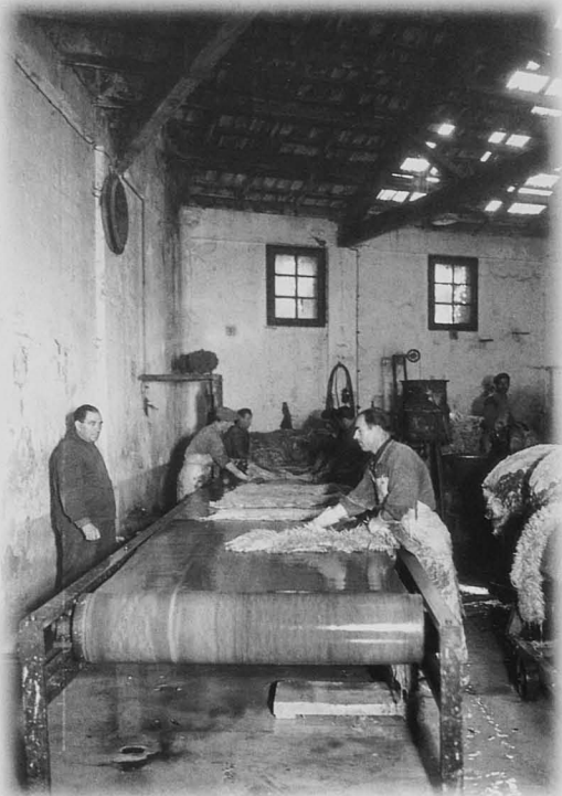
Operació d'empast les pells sobre cinta per treure'n el pèl.
