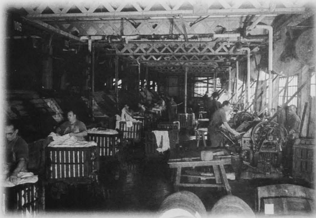
Ús intensiu de mà d'obra en les operacions d'escórrer a la secció d'adobs.
