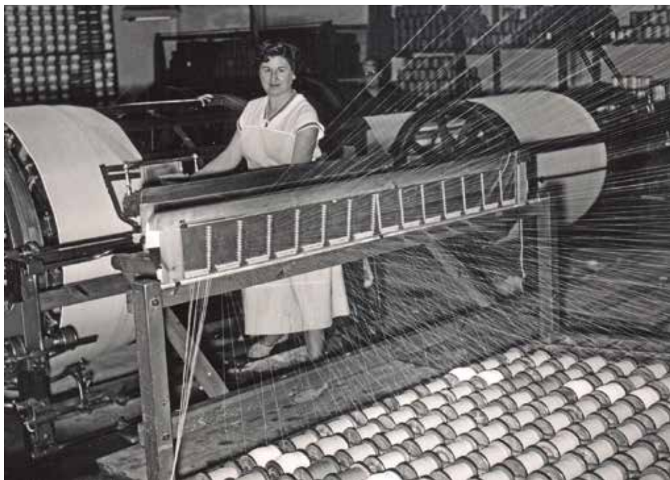
Figura 11. Una ordidora en plena feina a la fàbrica del Cotó
