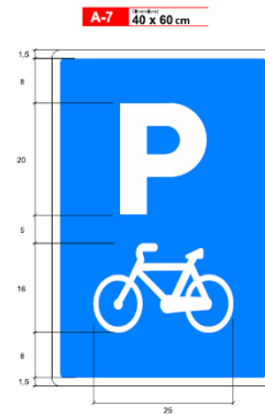
Figura 33. Senyalització vertical de pàrquing bici. Font: Manual de senyalització urbana de BCN.
