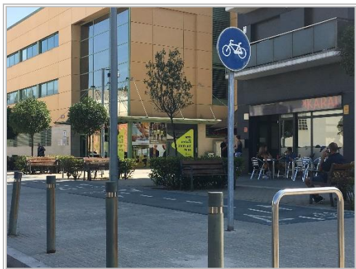
Imatge 23. Aparcaments segurs tipus "U invertida" al final de la vorera bici. Font: AIM, elaboració pròpia.
