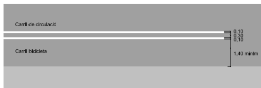
Figura 15. Carril bici unidireccional. Font: Manual de senyalització urbana de BCN.
