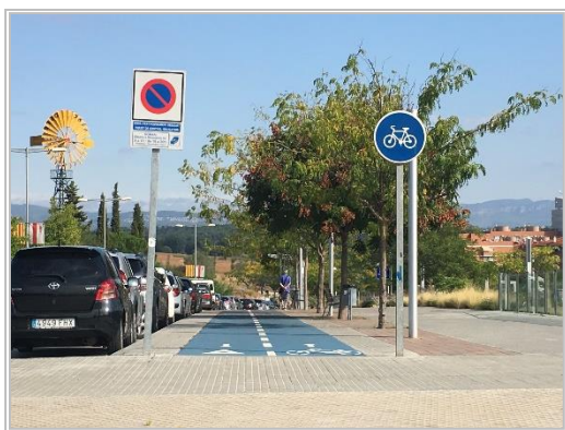
Imatge 11. Vorera bici de color blau de doble sentit. Font: AIM, elaboració pròpia.
