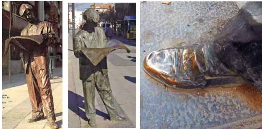
Figura 1: Lector de premsa. Esquerra: imatge de l'any 1993, pocs mesos després de la seva inauguració, on s'observa la tonalitat vermellosa de l'òxid de coure (I). Dreta: imatge actual en la qual el pas del temps ha afavorit la formació de l'òxid de coure (II) de color negrós i la tonalitat verdosa del carbonat de coure (II).
