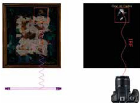
Figura 32. Exemple de la identificació de pigments amb la fluorescència d'infraroig. Font: CRBMC.
